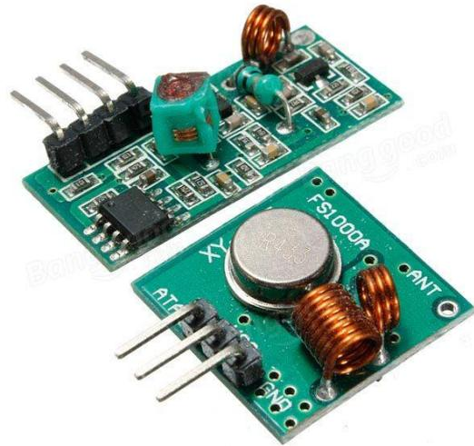
*Ilustración 11: Módulos transmisor y emisor de radiofrecuencia*
